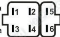
Existe un modelo de XR 250 L que no tiene corte por muleta y no llega el cable de instalación al pin 6. En ese caso es necesario conectar este pin a masa para que el CDI funcione.
