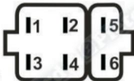
En caso de no funcionar el bulbo de corte de muleta, el pin 6 debe conectarse a masa.
