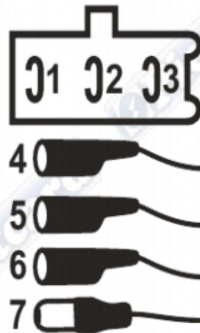
**BOBINADO GRUESO CON CONEXIÓN A MASA**
