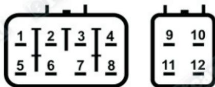
1- Verde: Bobina de Alta // 2- Negro con Rojo: Positivo del Switch de Start // 3- Sin Conexión // 4- Marrón: Positivo Batería // 5- Negro: Bobina de alta // 6- Verde con Negro: Muleta // 7- Sin Conexión // 8- Negro con Amarillo: Masa // 9- Sin Conexión // 10- Amarillo: Sensor // 11- Gris: Positivo Contacto // 12- Negro: Sensor
